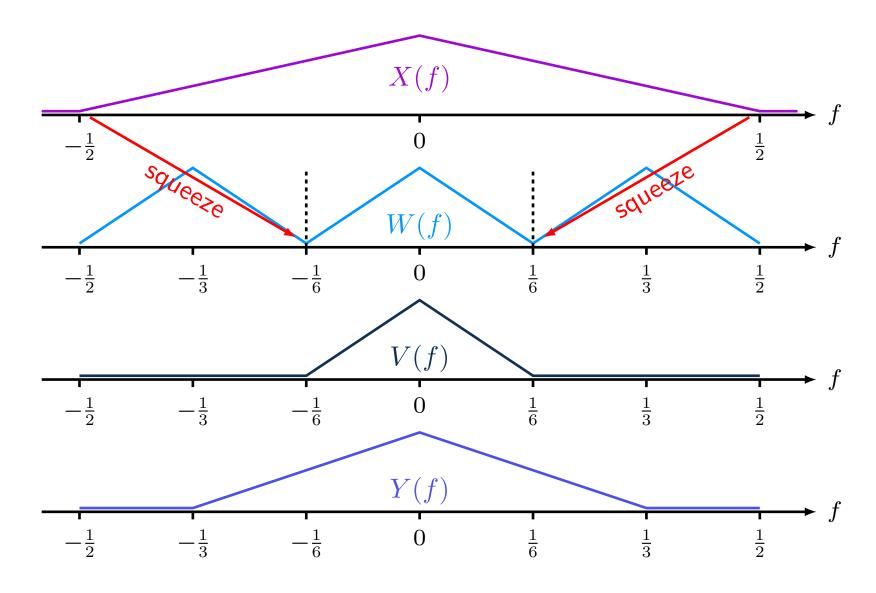
• input  $f_{\rm max}=1/2$ , output  $f_{\rm max}=(D/U)f_{\rm max}=1/3$
